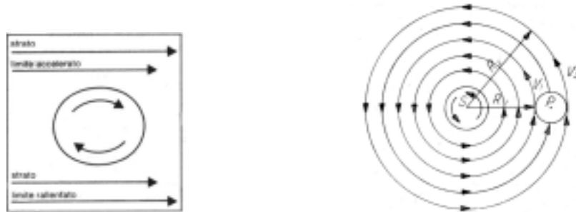
Fig. 3 – A sinistra: effetto Magnus. Le frecce indicano la direzione della corrente e all'interno di essa un cilindro, in sezione, messo in rotazione. A destra: campo rotante Todeschini con una sfera planetaria in rotorivoluzione attorno ad S.
