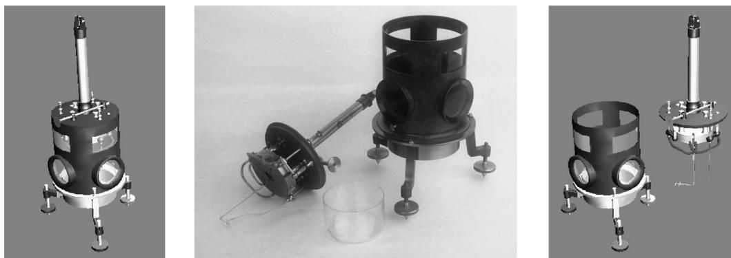
Fig. 5 L'elettrometro reale (al centro) e virtuale (ai lati) presentato intero e smontato.
