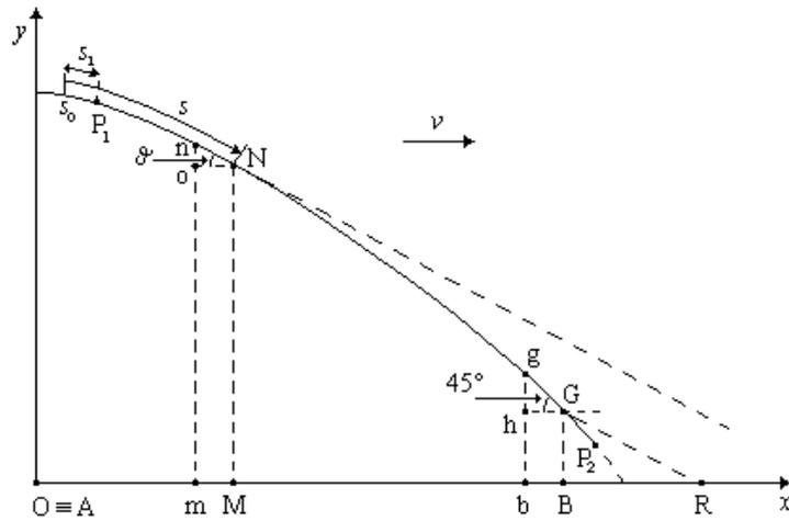
Figura 1 – La curva  $y=y(x)$  che, con la rotazione attorno al proprio asse (coincidente con l'asse  $x$ ), genera il solido di minima resistenza entrante nel mezzo con velocità  $v$ .
